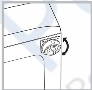
2. После установки машины на место отрегулируйте ее устойчивое положение путем вращения передних ножек (см. рис.). Для этого сначала ослабьте контргайку, после завершения регулировки контргайку затяните. После установки машины на место проверьте по
